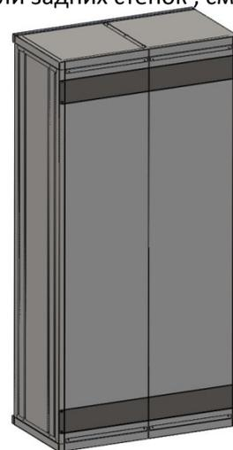
**Шаг 3.** С помощью винт М4 (Поз.16) и Гайка М4 (Поз.18) закрепите стенку среднюю (Поз.3) к поддону (Поз.7), см. схему.
