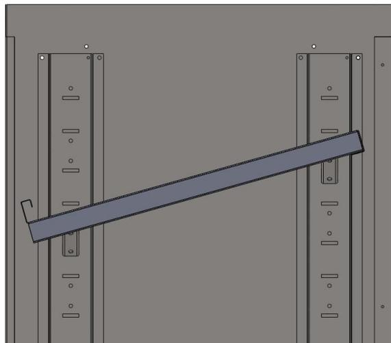
**Шаг 9.** – Установите двери на предустановленные установочные винты (П03.23) см. схему.
