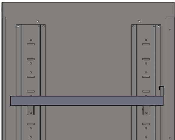
**Тип 2.** – Установка полки под наклоном
