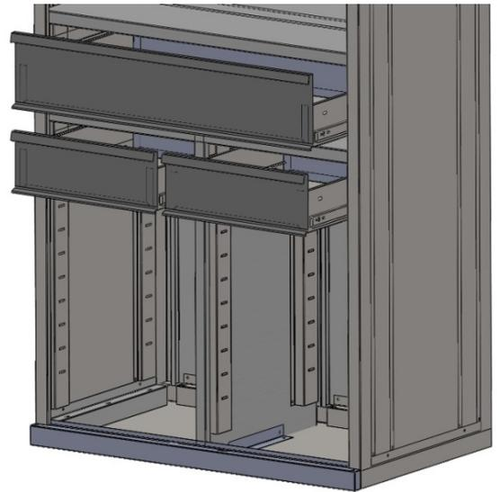
**Шаг 7.** – С помощью полкодержателей (Поз.19) установите полки (Поз.6 и 14) см. схему.
