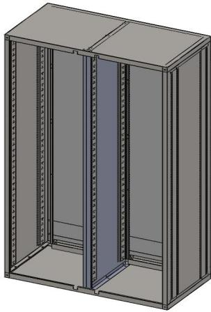
**Шаг 4.** с помощью Полкодержателей и Винт М4 (Поз.16) и Гайка М4 (Поз.18) установите и закрепите перемычку (Поз.11) к средней стенке (Поз.3), см. схему.
