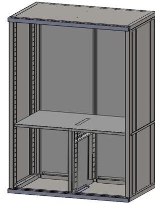
**Шаг 5.** – С помощью Саморезов М6,3 (Поз.21) закрепите Каркасы для ящиков см. схему.
