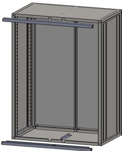
**Шаг 2.** – С помощью винтов М6х16 (ПОЗ.17) закрепите усилители задних стенок, см. схему.
